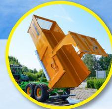
**Hydraulische 1-teilige Heckklappe
